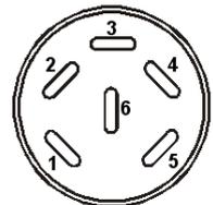
Abbildung 21: Pinbelegung der DIN Buchse (6)
