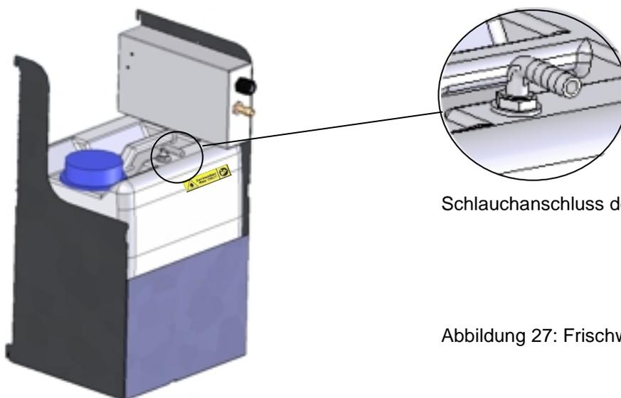
Schlauchanschluss des Frischwasserkanisters (18)
