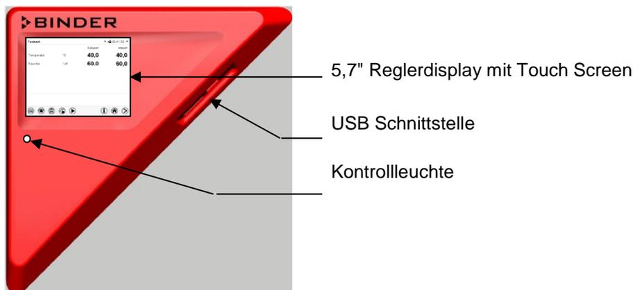
Abbildung 5: Instrumenten-Dreieck mit Programmregler MB2 und USB Schnittstelle
