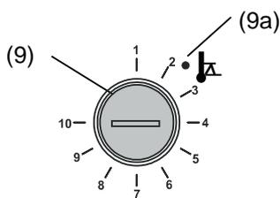
Beim TWW Kl. 3.2 wird entsprechend ein Minimalwert für die Temperatur eingestellt, der durch dessen Regelung nicht unterschritten wird. Diese Sicherung gegen unzulässige Temperaturunterschreitung dient z.B. als Schutz empfindlicher Kulturen gegen Auskühlung.
