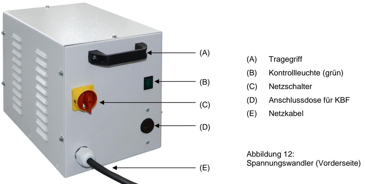
Zum elektrischen Anschluss des Konstantklimaschranks mit dem Spannungswandler gehen Sie in folgender Reihenfolge vor:
