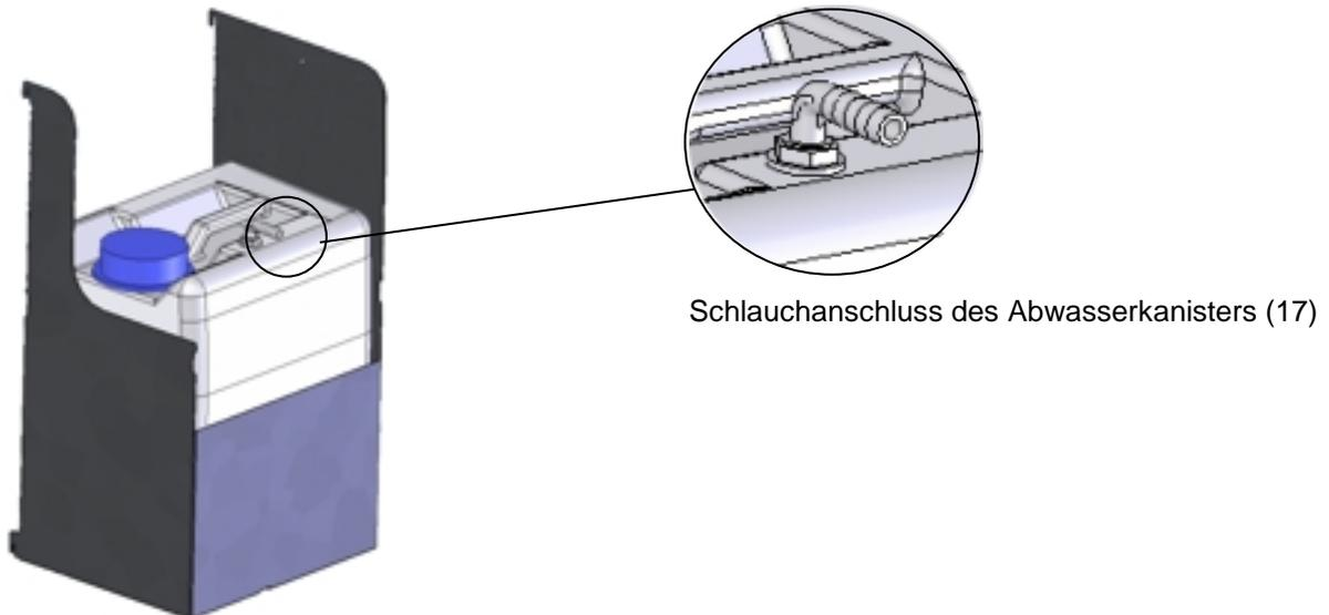
Schlauchanschluss des Abwasserkanisters (17)
