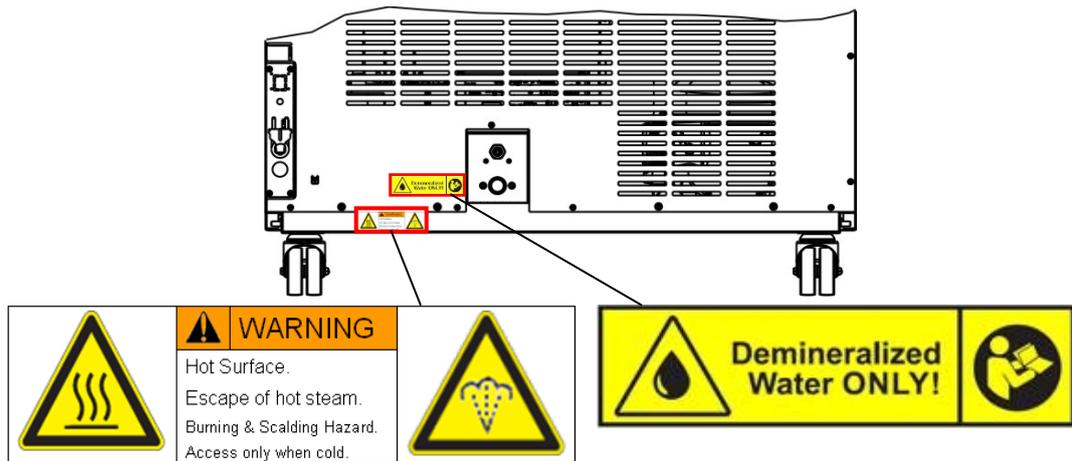
Abbildung 2: Position der Hinweisschilder an der Geräterückseite
