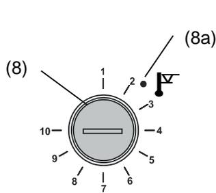
Bei Einstellung des Drehknopfes (8) auf Endanschlag (Position 10) fungiert der TWW Kl. 3.1 als Geräteschutz. Wird er etwas höher als auf die am Regler gewählte Solltemperatur eingestellt, fungiert er als Gutschutz.
