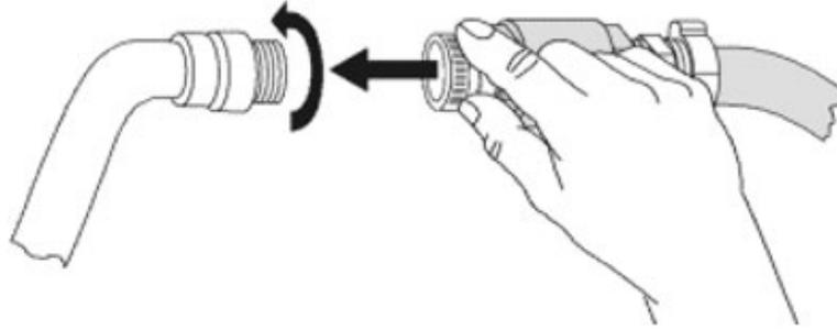
Abbildung 11: Montage des Sicherheitskits (Schlauchplatzsicherung mit Rückflussverhinderung)
