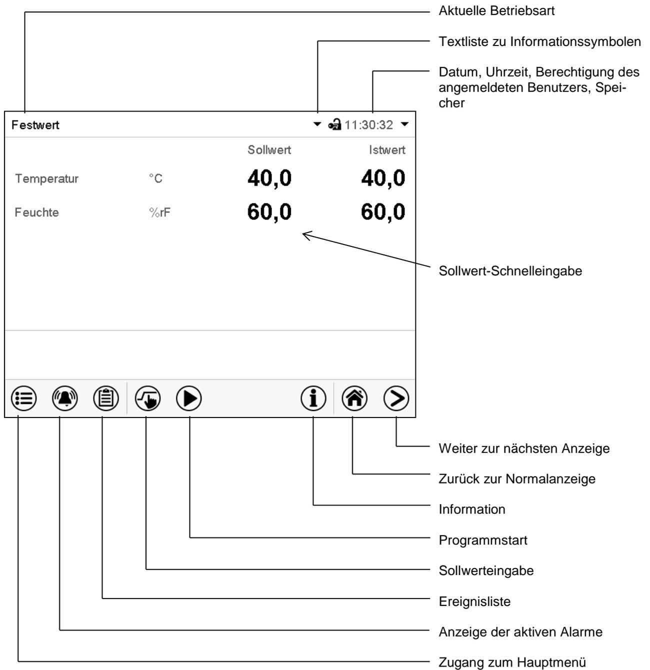
Abbildung 15: Bedienfunktionen des MB2-Reglers in der Normalanzeige (Beispielwerte)
